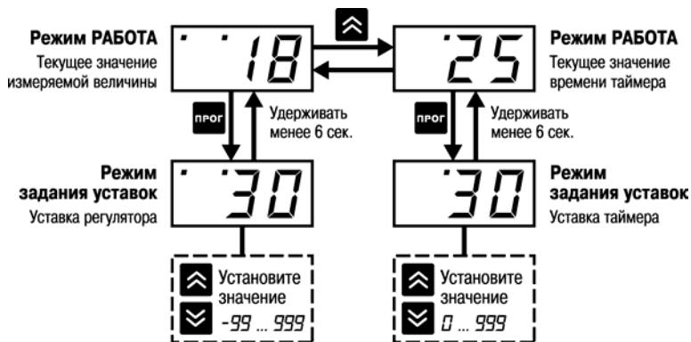
Рисунок 4.3 – Схема задания уставок регулятора и таймера
