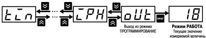
Рисунок 4.5 – Схема переключения между параметрами группы
