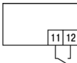
Рисунок 6.6 – Схема подключения внешней кнопки «СТОП/ПУСК»
